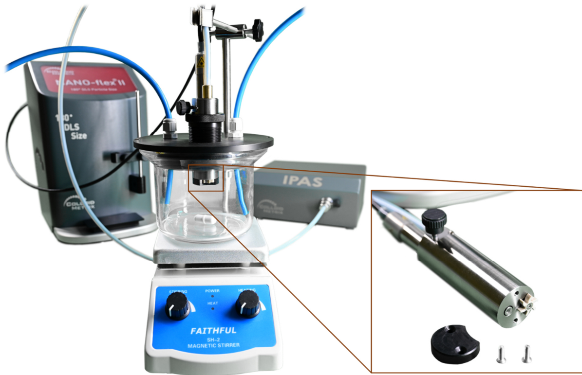
Bild 2: Messaufbau zur inline-Größenmessung der Mizellen (links: Durchflusszelle, rechts: IPAS-Messkopf)
